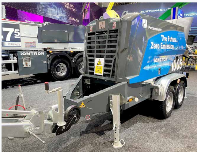
➤ Der PUTZMEISTER BSA 1005 iONTRON nutzt das 360-Volt-Antriebssystem von E-DEUTZ.
