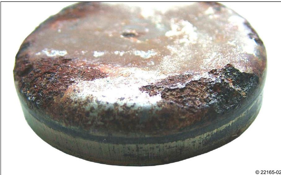
A11: Verschlussdeckel, korrodiert
