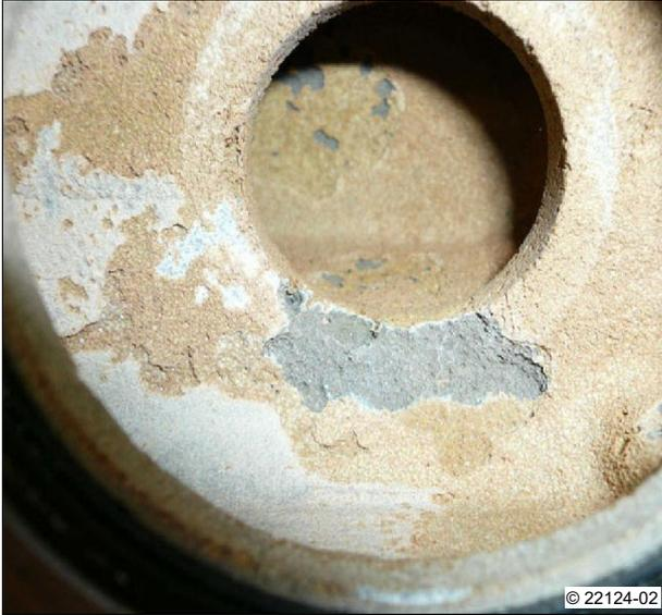
A12: Thermostatdeckel aus Aluminium, korrodiert
