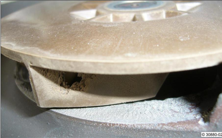
A15: Flügelrad der Kühlflüssigkeitspumpe, kavitiert
