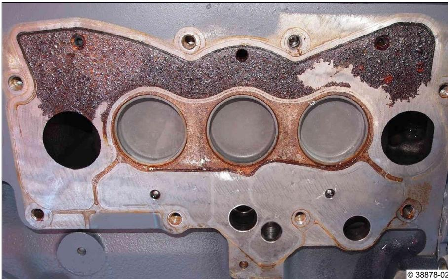
A7: Kurbelgehäuse im Bereich des Schmierölkühlergehäuses
