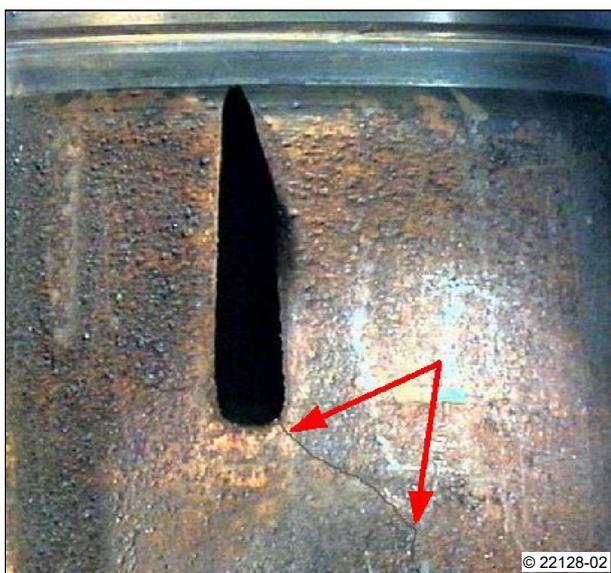
A3: Kurbelgehäuseriss im Bereich der Zylinderlaufbuchse
