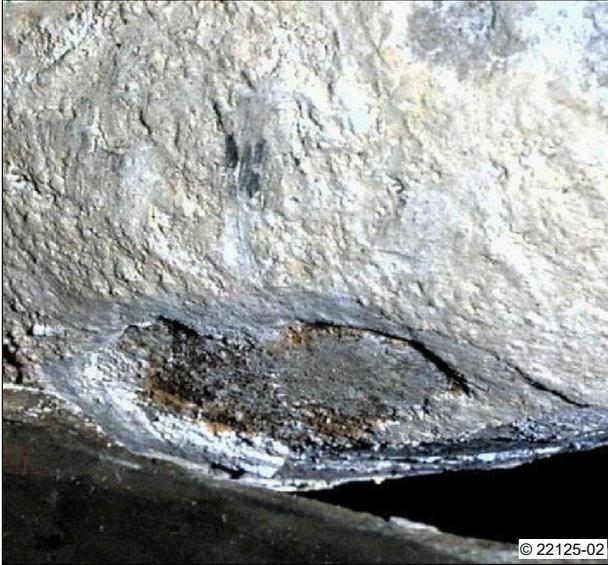
A13: Kalkablagerung an einer Zylinderlaufbuchse
