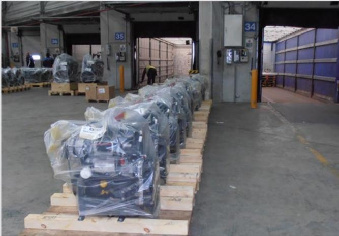
Moteurs avec capot de protection PE
